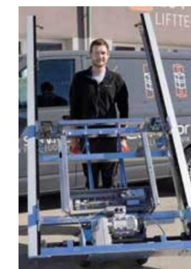
El UnaPorte® se puede montar en menos de 4 horas y no se necesita una grúa. A partir de 1,3 m, los carriles se seccionan. El elevador puede transportarse incluso a través de puertas con una anchura de paso de 90 cm.
