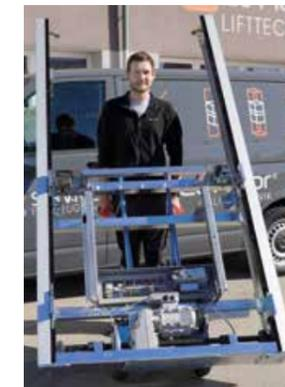
In **weniger als 4 Stunden** kann der UnaPorte® montiert werden und es wird kein Kran benötigt. Selbst durch Türen mit 90 cm Durchgangsbreite kann der Lift transportiert werden.
